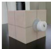
Fig.2 Water-equivalent phantom.
